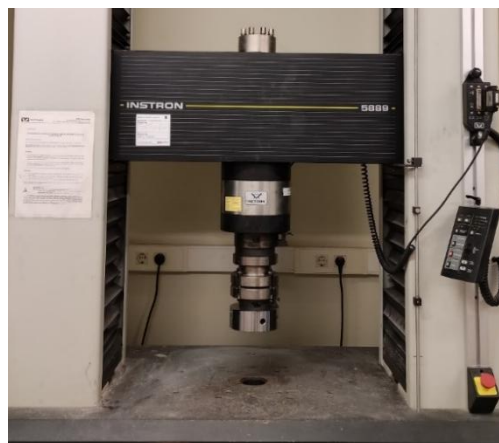
Figura 5. Máquina de ensayos universales Instron 5889 empleada en los procedimientos de calibración.
